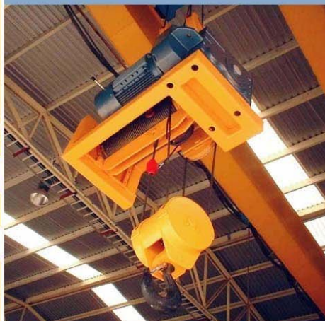
MALACATE de 4 toneladas de capacidad para grúa viajera monopuente de clase de servicio "D".
