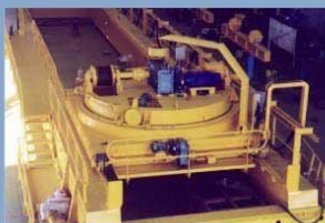
MALACATE de 5 toneladas de capacidad, 250m de izaje, para el montaje de fachadas en la torre mayor (D.F.)
