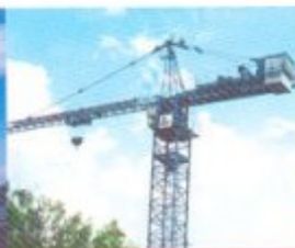
Grúa Torre de 18t. de capacidad en la punta con 20m. de brazo D.D.F.
