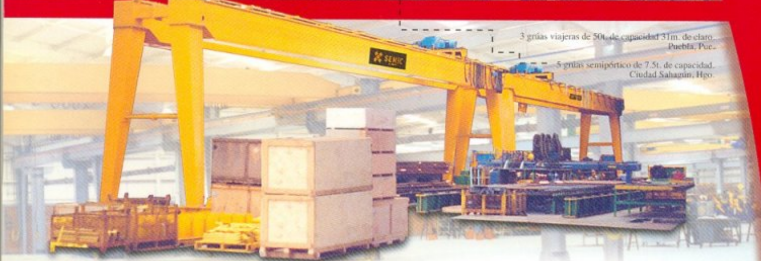
2 grúas viajeras tipo pórtico de 15t. de capacidad. Ciudad Sahagún, Hidalgo.
