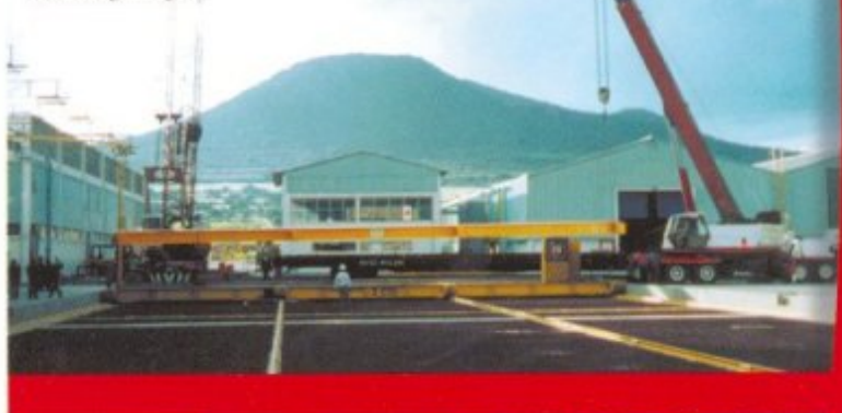
Carro transbordador para carros de ferrocarril, 50t. cap. Cd. Sahagún, Hgo.
